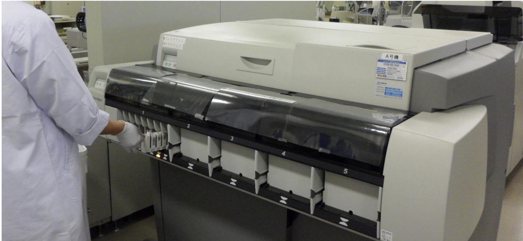
全自動化学発光免疫測定装置 アボット ARCHITECT アナライザー i2000SR
