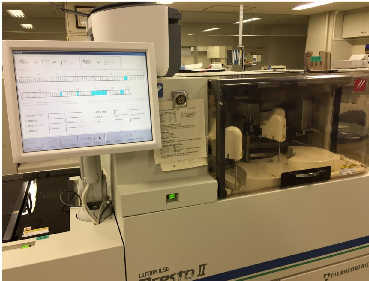
全自動化学発光免疫測定装置 富士レピオ ルミパルス プレストII
